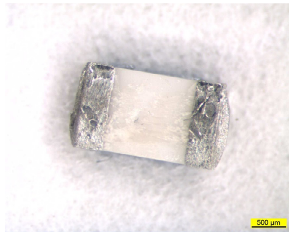
Abbildung 92: Bruch im Lot, Bauteil
