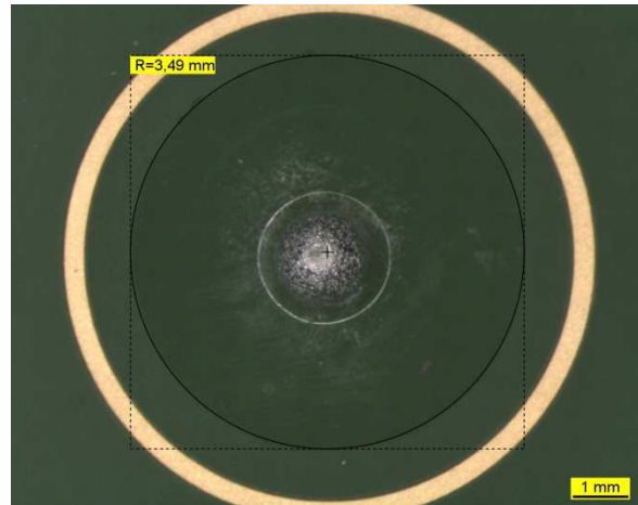
Abbildung 60: Solderball mit vermessenem Flussmittel
