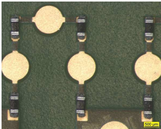
Abbildung 30: R0201 bestückt, Pos. 1-5, 0µm Versatz
